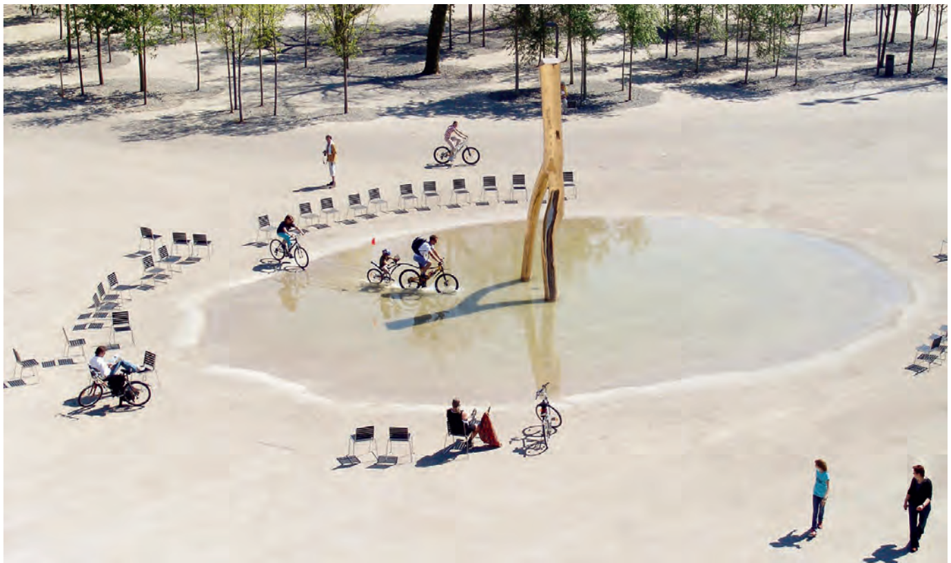
Die Sammlung und Verdunstung von Regenwasser an der Oberflächen macht das Prinzip der Schwammstadt sichtbar und erlebbar. Festspielhaus, Bregenz
